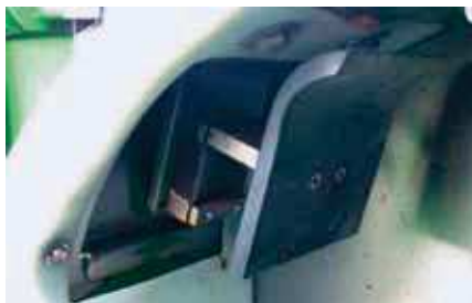
Rysunek 4.1.10. Widok płyty oporowej czujnika pomiaru natężenia przepływu.
