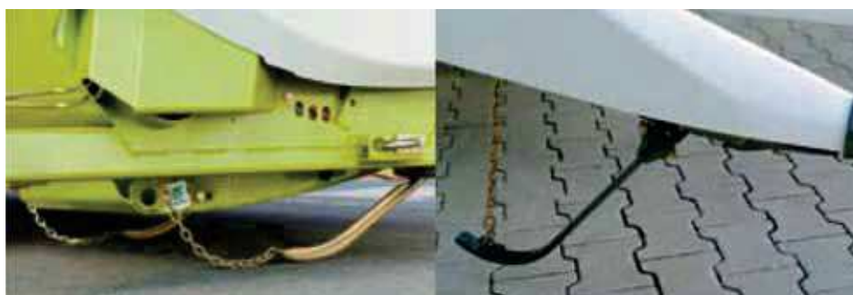
Rysunek 4.1.7. Przykład rozwiązania w kombajnie Claas (Auto contour) do stabilizacji położenia hedera względem gleby.
