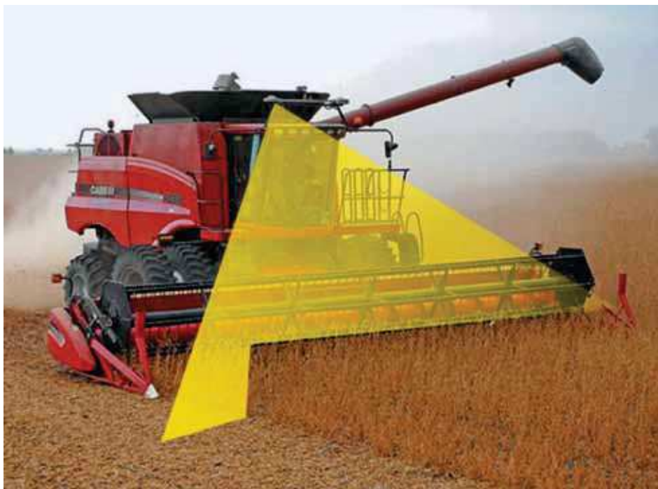
Rysunek 4.1.4. Pomiar krawędzi łanu za pomocą czujnika laserowego.
